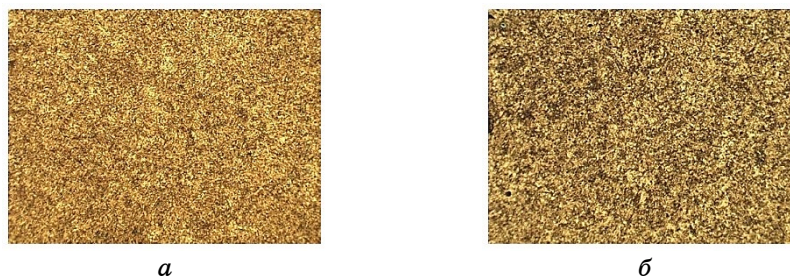
Рис. 6. Мікроструктура дослідного зливка № 3 після загартування від: 800°C ( a ), 850°C ( б ), 900°C ( в ), 950°C ( г ). \times 100 .
